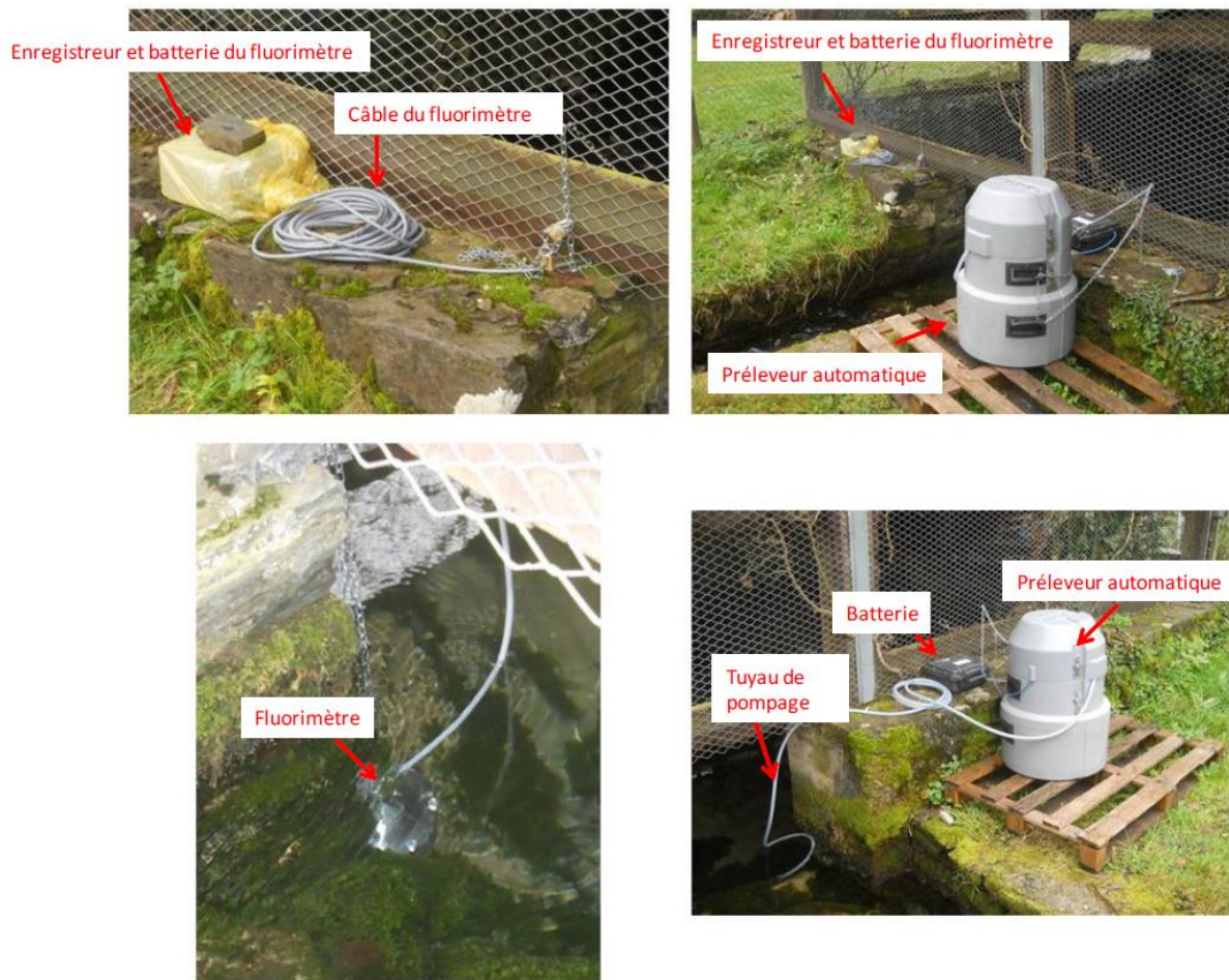
Figure 36 : Exemple d'instrumentation d'un point de suivi lors d'un essai de traçage
